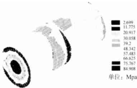
图 10 螺旋圆锥齿轮组件有限元模型 Fig 10 The FEM model of the spiral bevel gears
